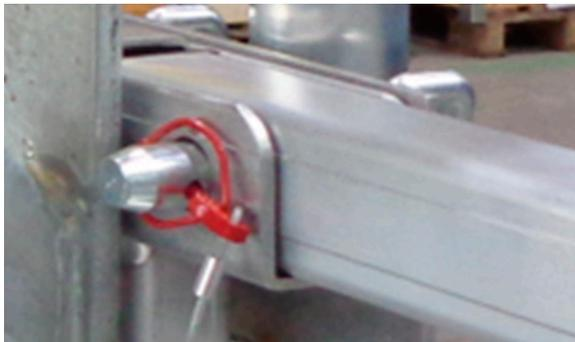
Steckbare Bühnenverbindungen, ohne Werkzeug bedienbar, mit Verliersicherung
