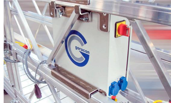
Zentralsteuerung für beide Treibscheibenwinden G-trac
