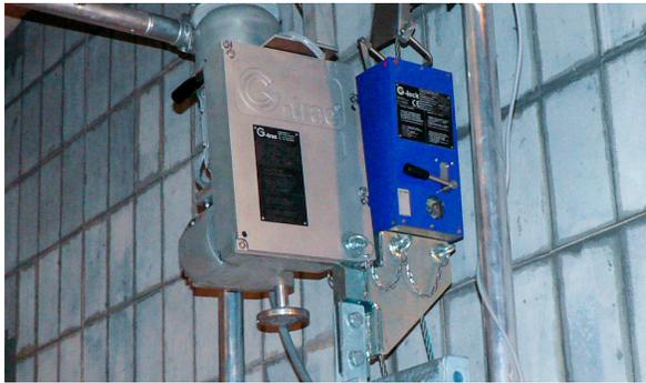
Treibscheibenwinde G-trac mit Notablassfunktion und Fangvorrichtung G-lock
